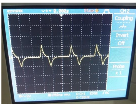
Gambar 3. 6 Bentuk gelombang output penguat 2 non inverting dan low pass filter 2
