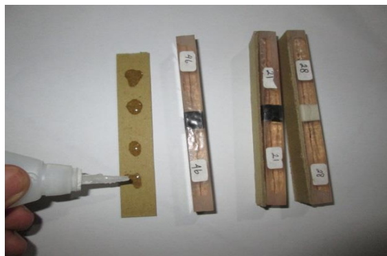
Gambar 3.27 Pengeleman spesimen dengan karton
