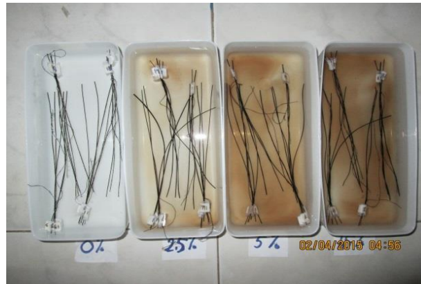
Gambar 3.18 Perendaman serat dengan air
