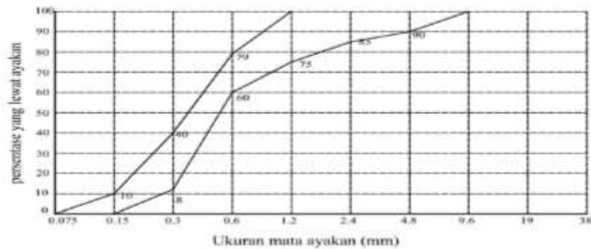
Gambar 3.6. Batas gradasi pasir pada daerah no.2 (Tjokrodimuljo, 2007 )
