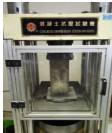
Gambar 16 Pengujian Kuat Tekan
