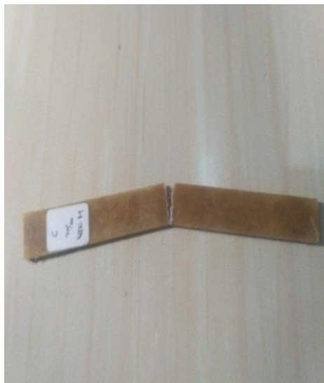
Gambar 4.1 Hasil uji impact charpy Gambar 4.2 Spesimen dengan v-notch
