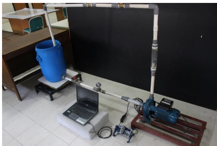
Gambar 3. 2 Test-rig kavitasasi pompa sentrifugal
