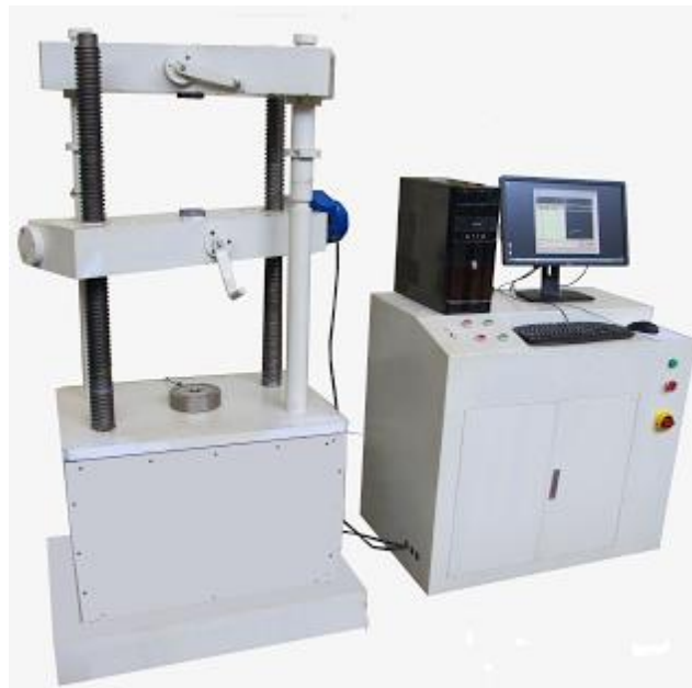
Gambar 1. Universal Testing Machine, Alat Uji Kekuatan Fleksural dan Kekuatan Tarik
