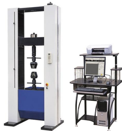
Gambar 4. Universal Testing Machine tipe vertical (horizontal) dual test stand dengan model ASL-S dari Jinan Kason Testing Equipment Co., Ltd.
