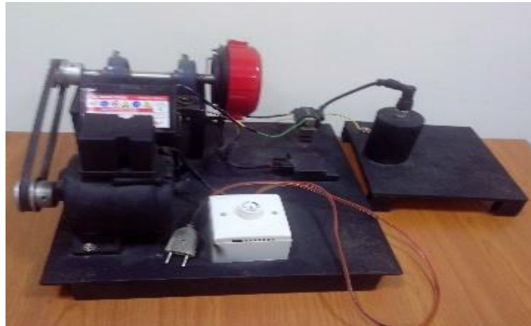
Gambar 3.11 Alat penguji percikan bunga api pada busi
