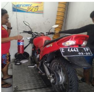
Gambar 3 Proses pengujian dynotest menggunakan dynamometer
