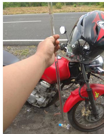
Gambar 4 Proses pengujian konsumsi bahan bakar
