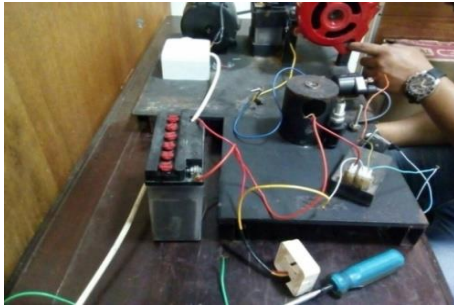
Gambar 2 Proses pengujian percikan bunga api
