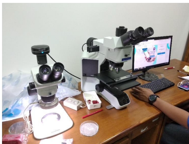
Gambar 3.8 Mikroskop optik OLYMPUS-SZ61TR
