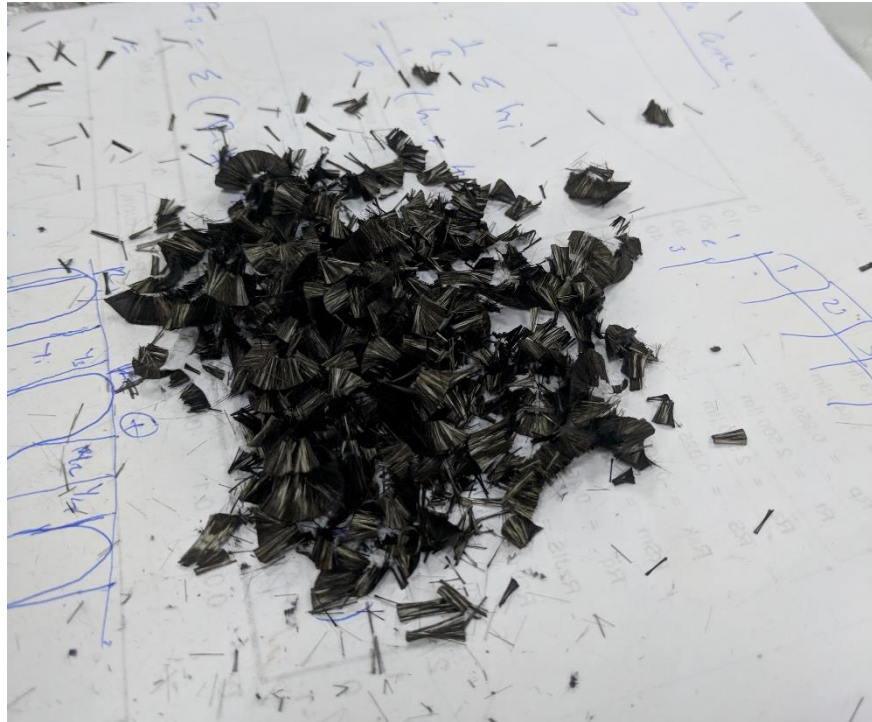
Gambar 3.16 Serat karbon yang sudah dipotong sepanjang 5 mm
