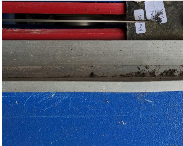
Gambar 3.30 pemotongan spesimen uji penyerapan air
