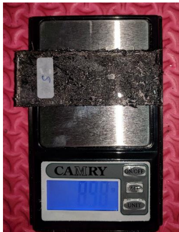
Gambar 3.31 Penimbangan spesimen sebelum direndam
