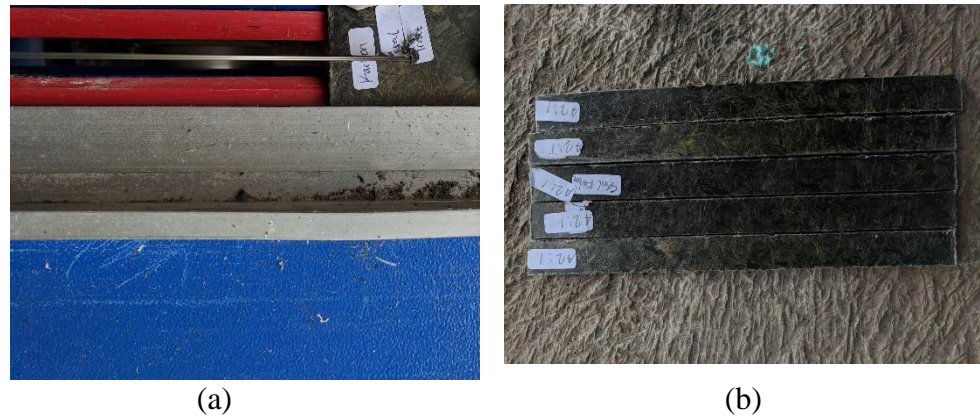
Gambar 3.26 proses pemotongan spesimen uji bending. (a) Proses Pemotongan. (b) Hasil pemotongan.
