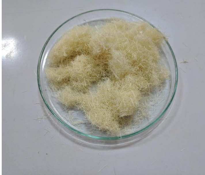
Gambar 3.13 serat sisal yang dipotong dengan ukuran 5mm
