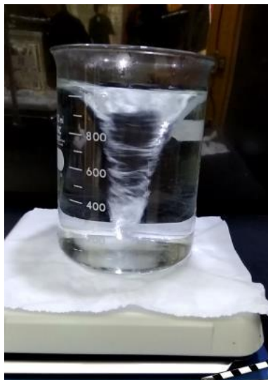
Gambar 3.22 Asam asetat diaduk menggunakan magnetic steering
