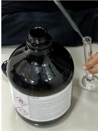
Gambar 3.21 Pengukuran larutan asam asetat untuk dicampur ke akuades
