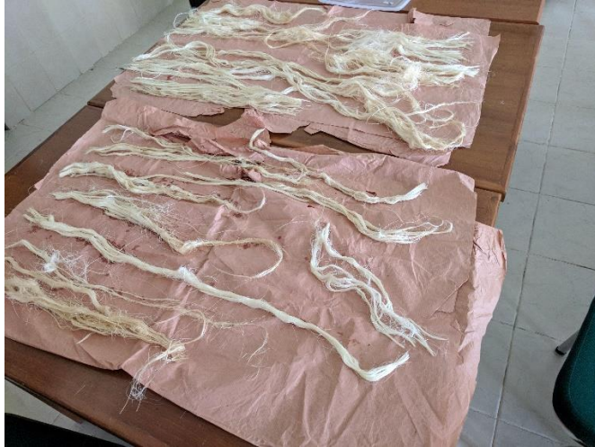
Gambar 3.10 pengeringan serat sisal setelah dicuci menggunakan air
