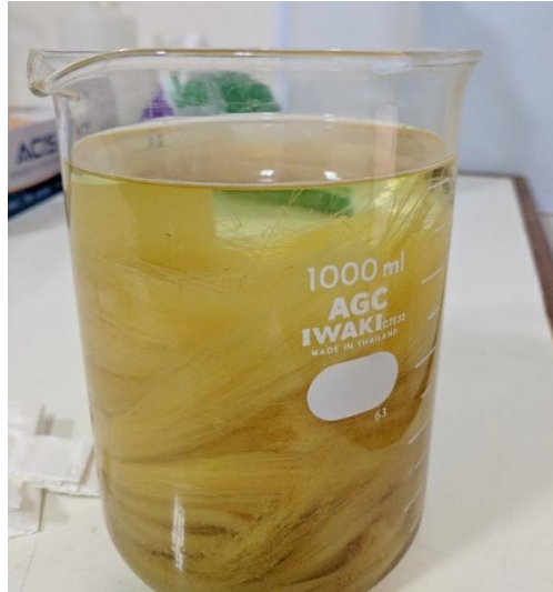
Gambar 3.12 Serat sisal direndam menggunakan larutan NaOH
