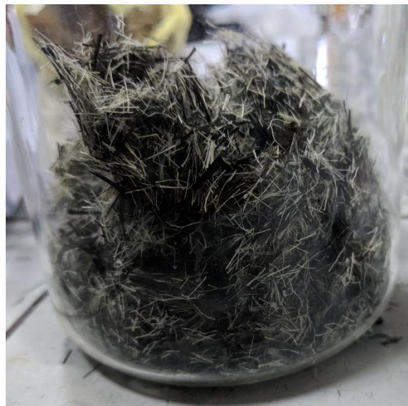
Gambar 3.24 Serat sisal dan serat karbon dicampur didalam gelas beker
