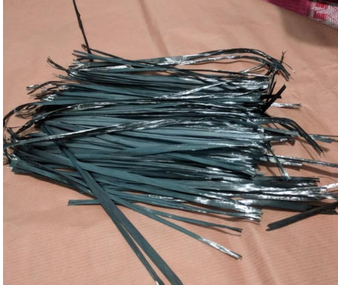
Gambar 3.14 Serat karbon yang dipotong sesuai ukuran wadah nitrogen cair
