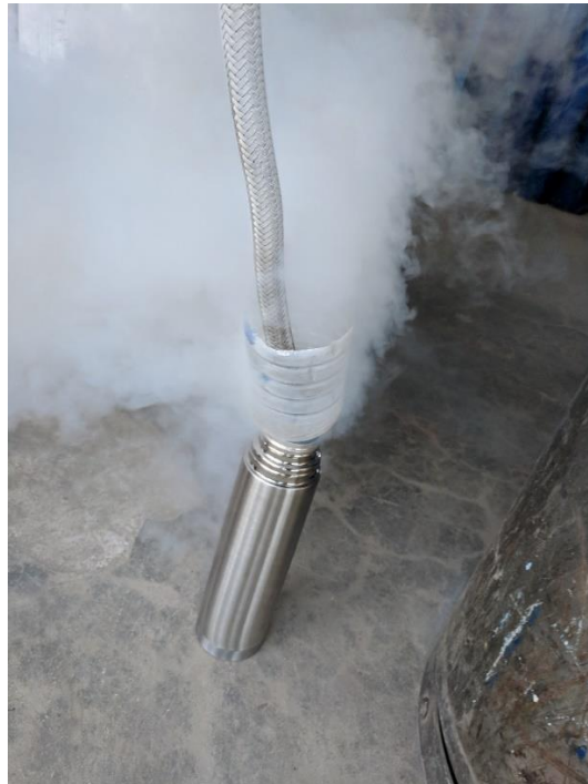
Gambar 3.15 Proses penuangan nitrogen cair
