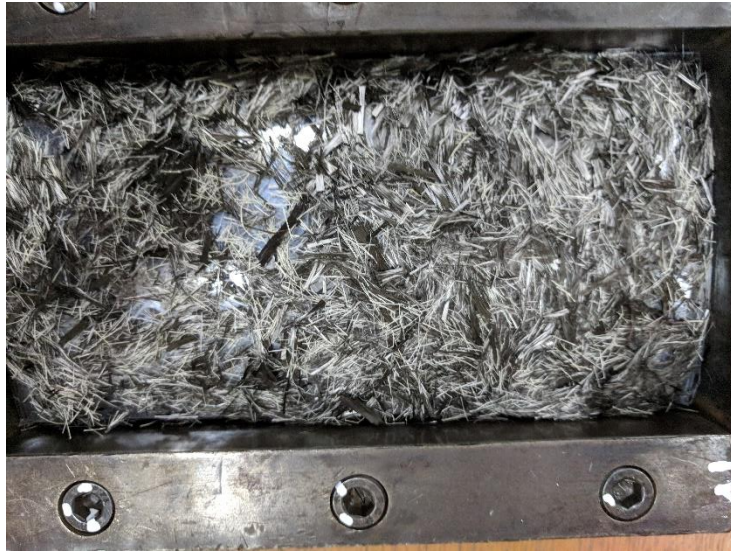
Gambar 3.25 penyusunan serat sisal, serat karbon dan PVC ke dalam cetakan
