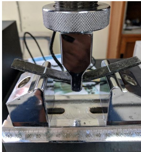
Gambar 3.29 Penekanan spesimen uji
