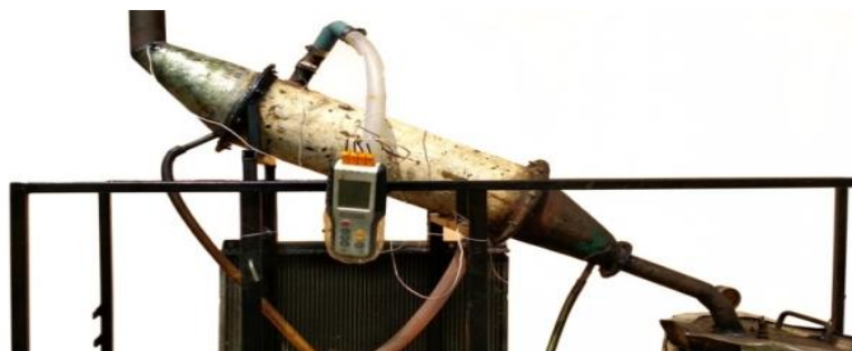
Gambar 3.19 Variasi sudut kondensor (c) sudut 30^{\circ} .
