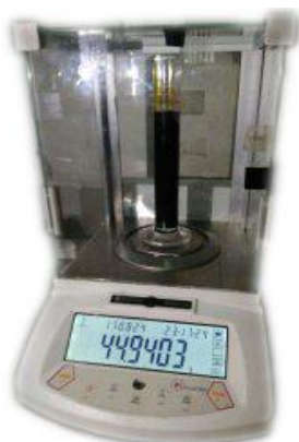
Gambar 3.24 Timbangan digital dan gelas ukur.
