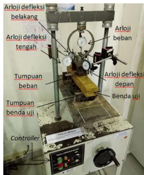
Gambar 3.7 Detail alat uji lentur balok
