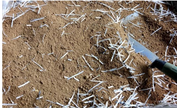
Gambar 3.14 Pencampuran benda uji
