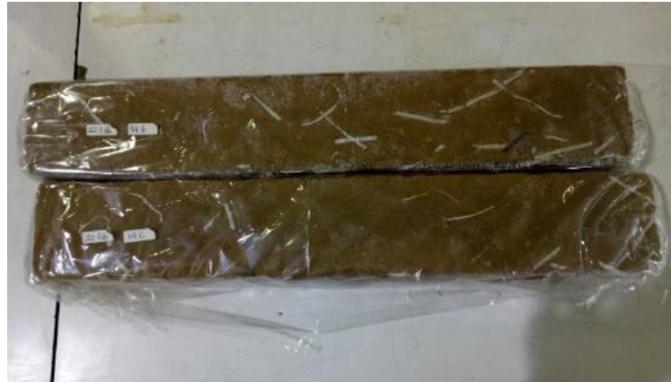
Gambar 3.17 Cara pengeraman benda uji
