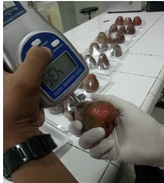
L. Pengamatan Uji Kekerasan menggunakan fruit pnetrometer
