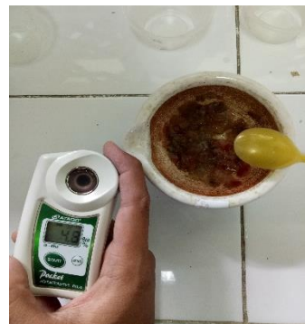
M. Pengamatan Gula Total menggunakan hand refractometer
