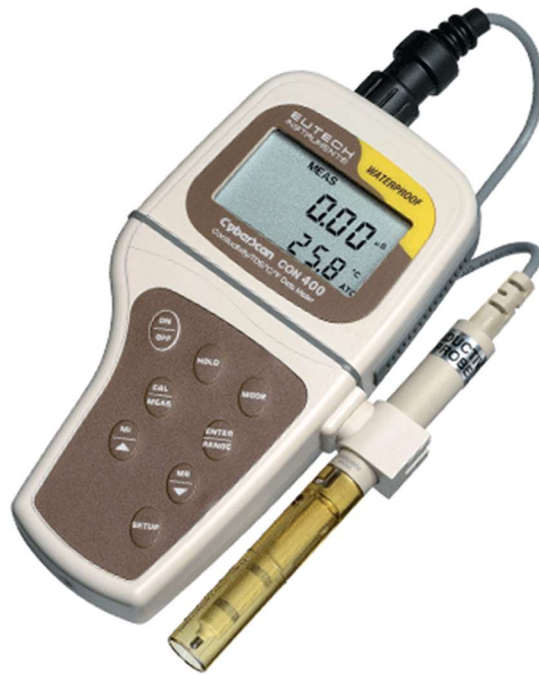
Gambar 3.21 Alat pengukur daya hantar listrik / konduktivitas Cyberscan CON 400 ( www.eutechinst.com )
