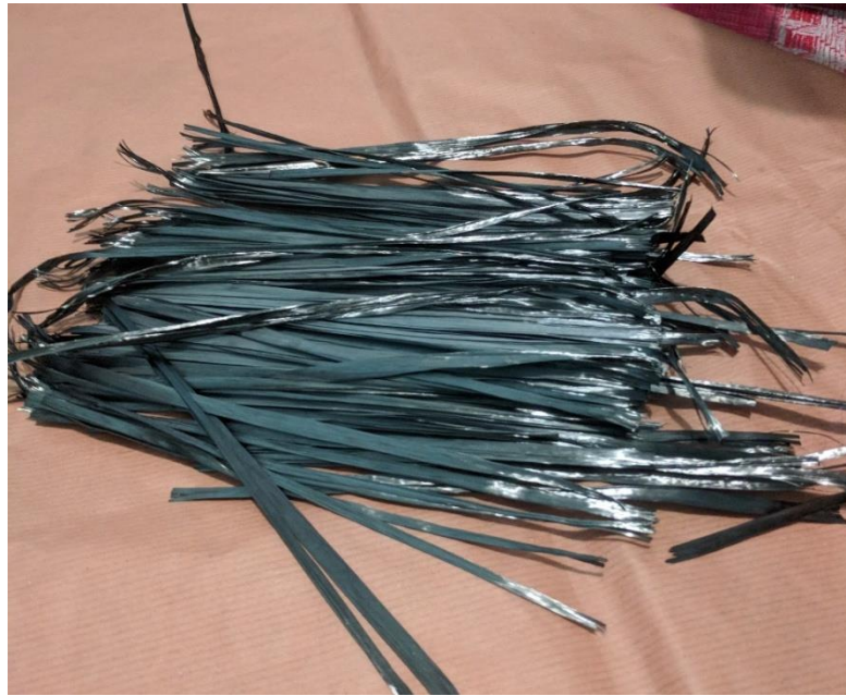
Gambar 3. 13 Serat karbon dipotong menurut wadah nitrogen cair
