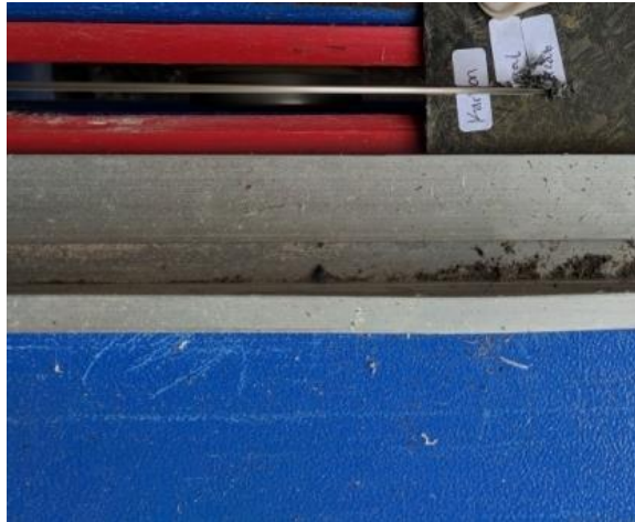
Gambar 3. 22 Pematangan spesimen uji bending
