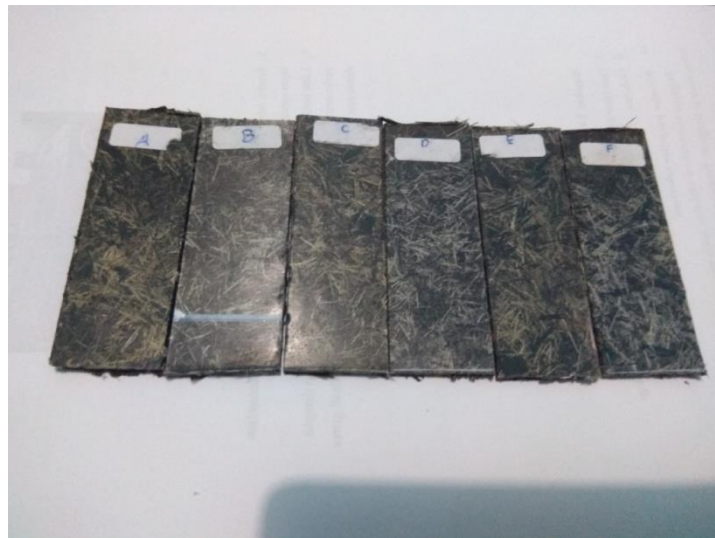
Gambar 3. 27 Spesimen uji daya serap air
