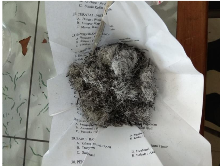
Gambar 3. 19 Pencampuran serat karbon/sisal
