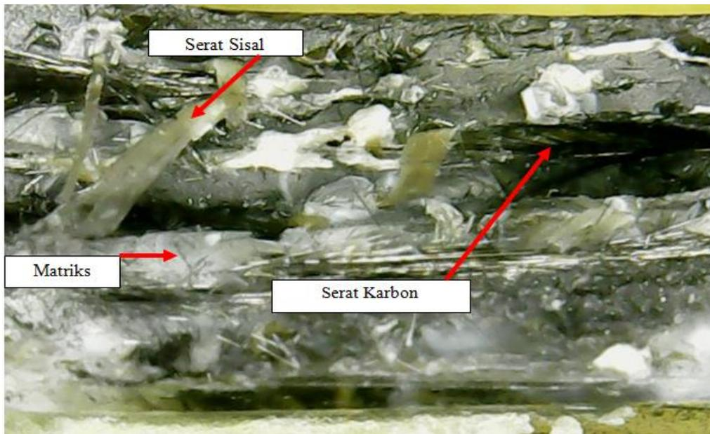
**Gambar 4. 7** Foto mikro spesimen komposit serat karbon/serat sisal/PVC dengan perbandingan serat sisal 1:1 serat karbon
