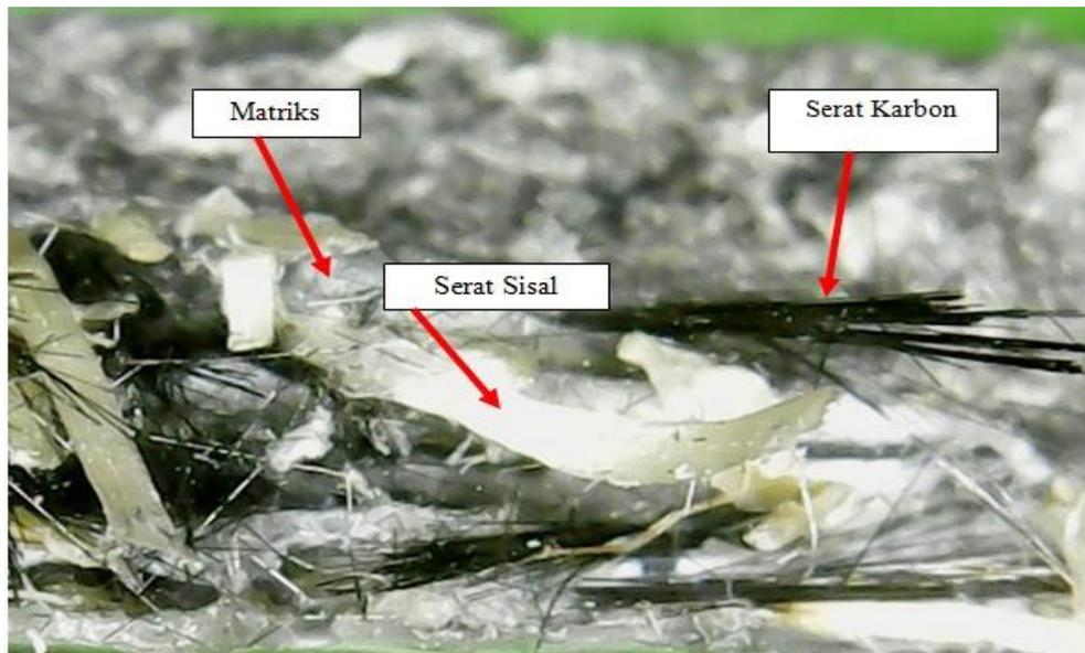
**Gambar 4. 8** Hasil foto mikro spesimen komposit serat karbon/serat sisal/PVC dengan perbandingan serat sisal 2:1 serat karbon
