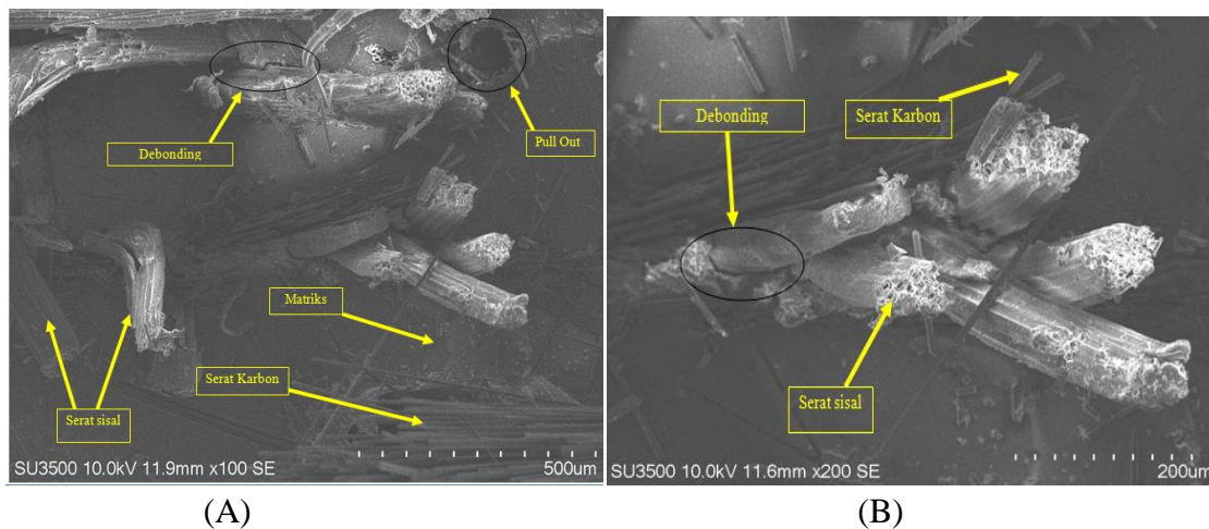
Gambar 5. (A) Struktur patahan hasil uji SEM sisal/karbon 2:1 dengan perbesaran 100x (B) struktur patahan hasil uji SEM sisal/karbon 2:1 dengan perbesaran 200x
