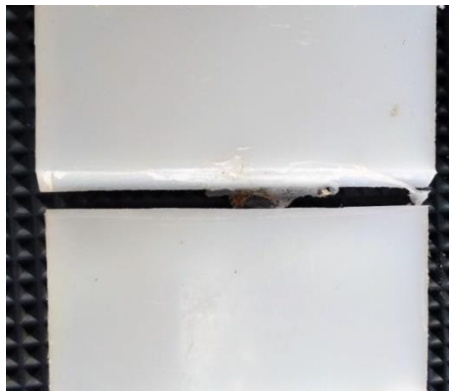
Gambar 4.30 Patahan hasil sambungan lem pipa PVC
