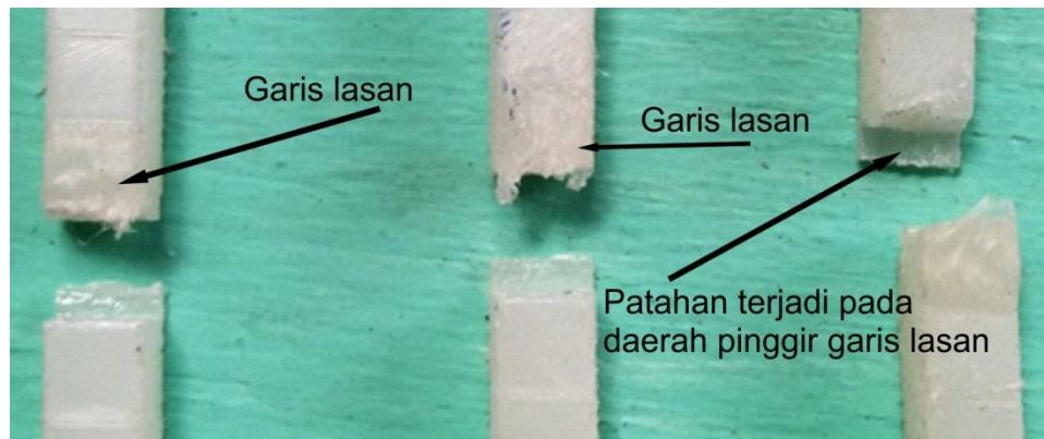
Gambar 4.20 Patahan setelah uji tarik hasil pengelasan FSW dengan bentuk pin silinder ulir diameter 4mm
