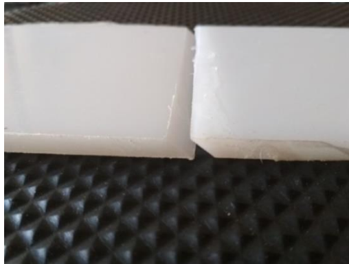
Gambar 4.28 Pembentukan sudut kontak spesimen penyambungan
