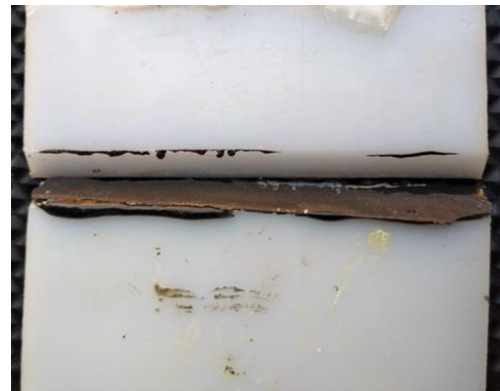
Gambar 4.31 Patahan hasil penyambungan dengan lem plastic steel
