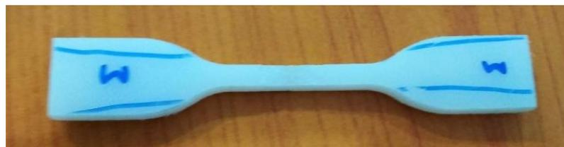
Gambar 5 Spesimen uji tarik
