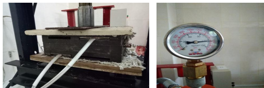
Gambar 3.23 Pemasangan cetakan dan mengatur tekanan pada alat press
