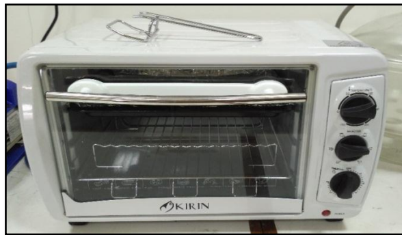
Gambar 3.20 proses pengovenan serat kenaf
