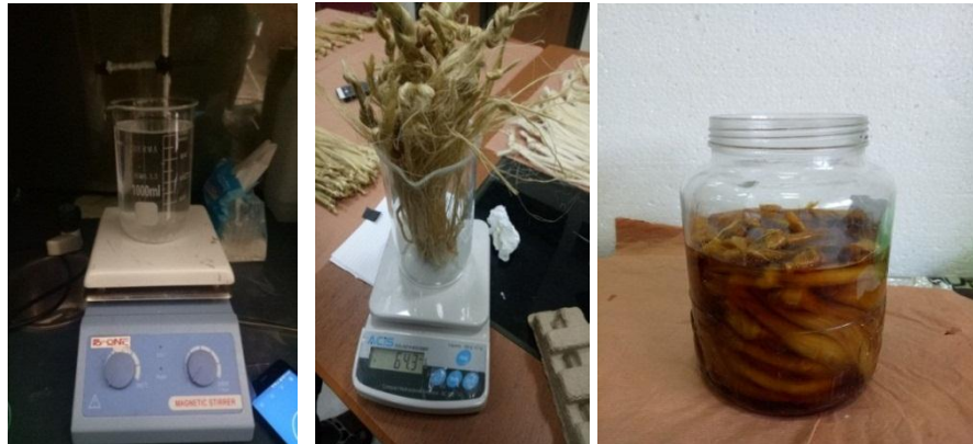
Gambar 3.17 pelarutan serat kenaf dengan NaOH
