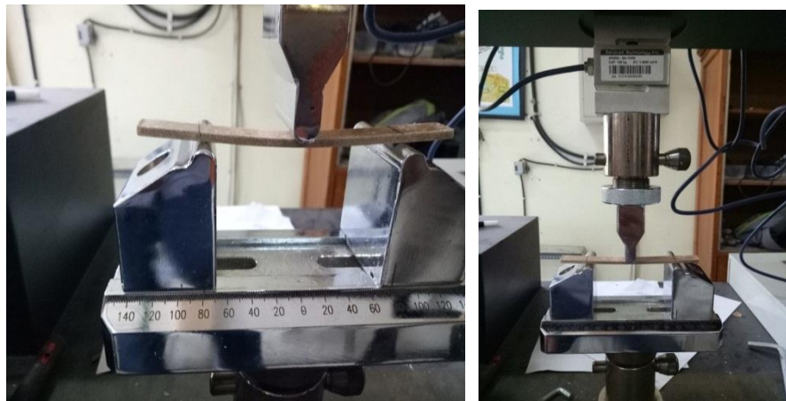
Gambar 3.29 pemasangan spesimen pada alat uji.
