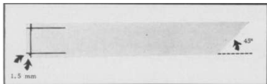
Gambar 2. Alat ukur indeks malalignment (Van Kirk dan Pennell, 1959)
