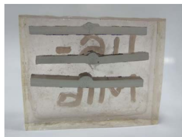
Gambar 3.15 Spesimen uji kekerasan dan uji struktur mikro
