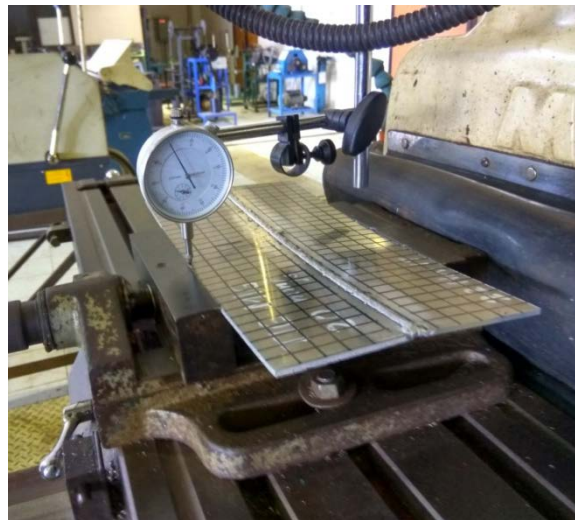
Gambar 3.9 Pengukuran distorsi dengan dial indikator pada meja milling
