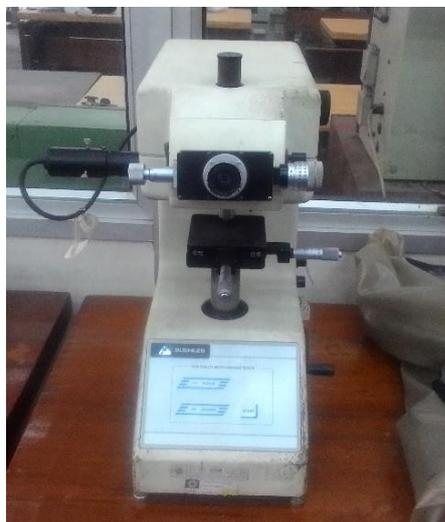
Gambar 3. 16 Alat uji kekerasan *buehler*
