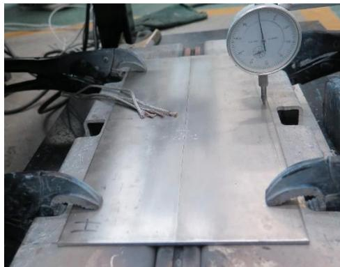
Gambar 3. 3 Persiapan pemasangan spesimen
