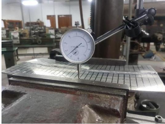
Gambar 3. 9 Pengukuran distorsi dengan alat dial indikator
