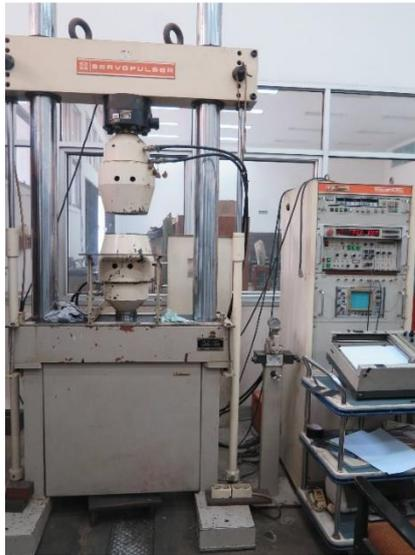
Gambar 3. 11 Mesin uji tarik servopulser
