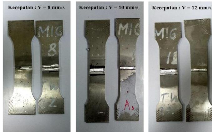
Gambar 4. 13 Spesimen uji tarik
