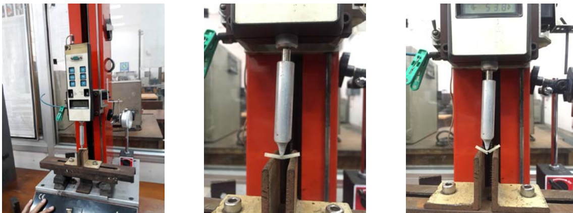
Gambar 19. Pengujian kekuatan fleksural menggunakan alat UTM dengan beban awal 1 Newton
