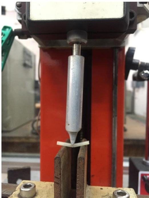
Gambar 16. Pengujian menggunakan UTM dengan beban awal 1 Newton
