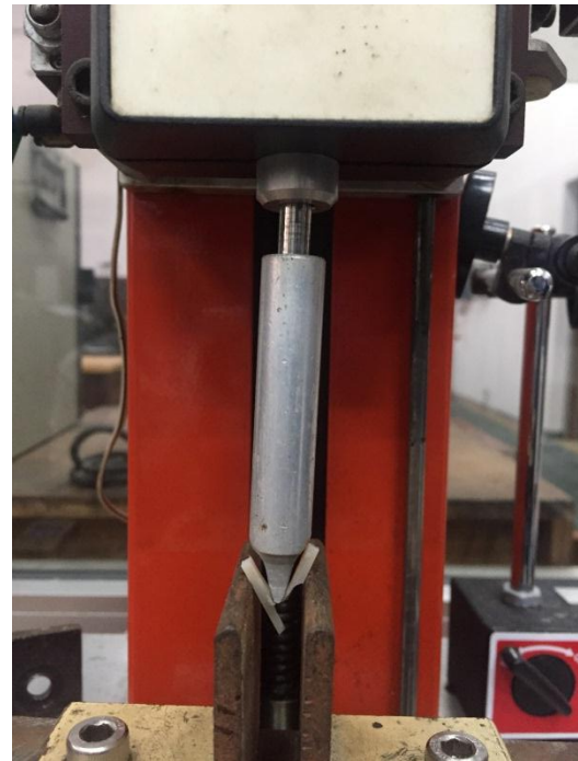
Gambar 16. Pengujian menggunakan UTM dengan beban awal 1 Newton
