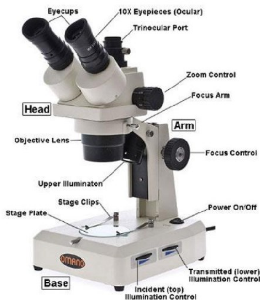
Gambar 2.9. Bagian-bagian mikroskop optik
