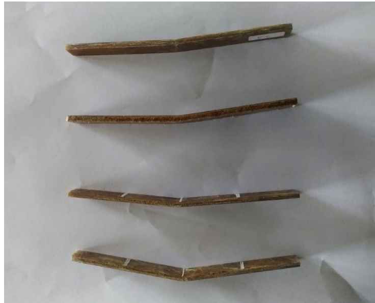
Gambar 4.1 Spesimen uji bending setelah di uji
