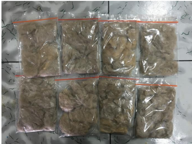
Gambar 3.37 Serat E-glass Yang Sudah Dipotong
