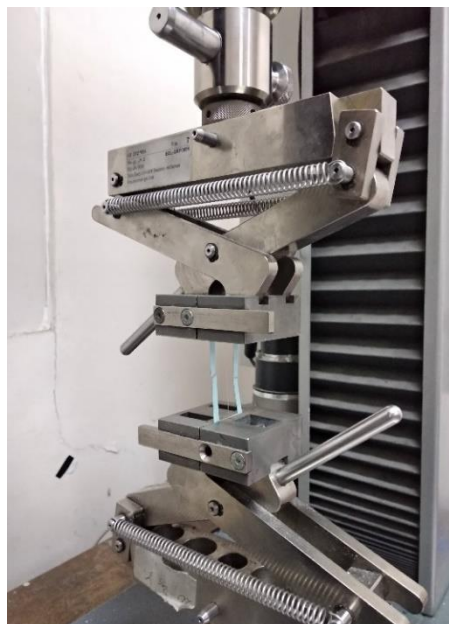
Gambar 3.40 Pemasangan spesimen uji tarik serat tunggal
