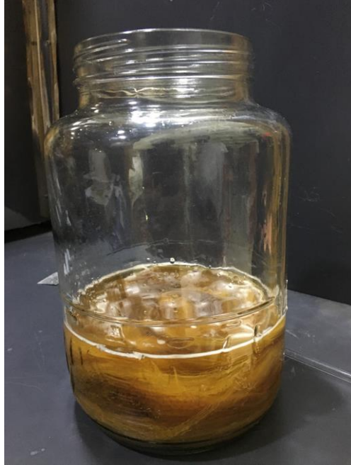
Gambar 3.32 Perendaman Serat Nanas Dengan NaOH
