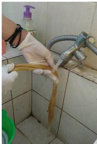
Gambar 3.34 Proses Pembilasan Serat Nanas
