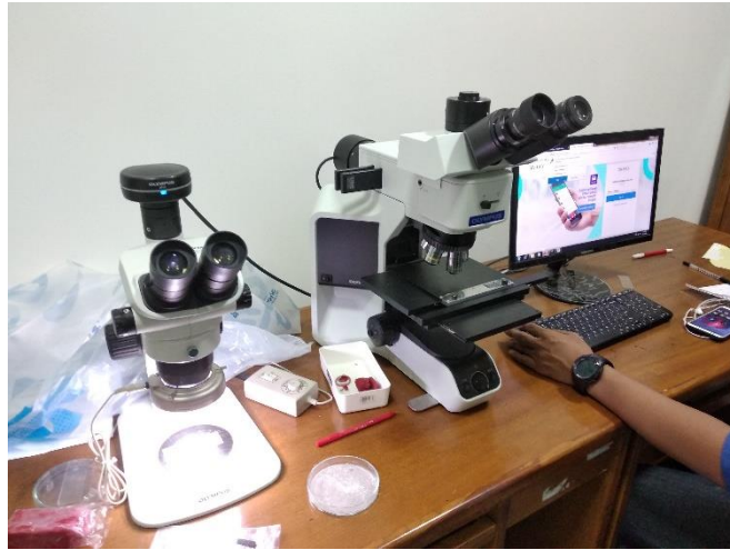
Gambar 3.18 Mikroskop Optik OLYMPUS-SZ61TR
