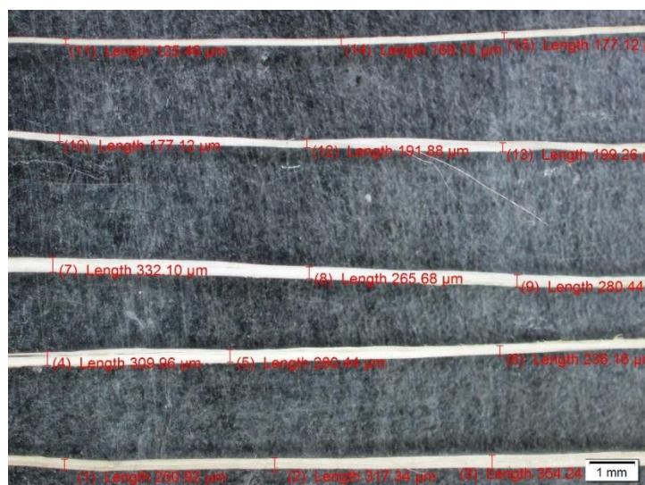
Gambar 3.38 Hasil pengukuran diameter serat menggunakan mikroskop
