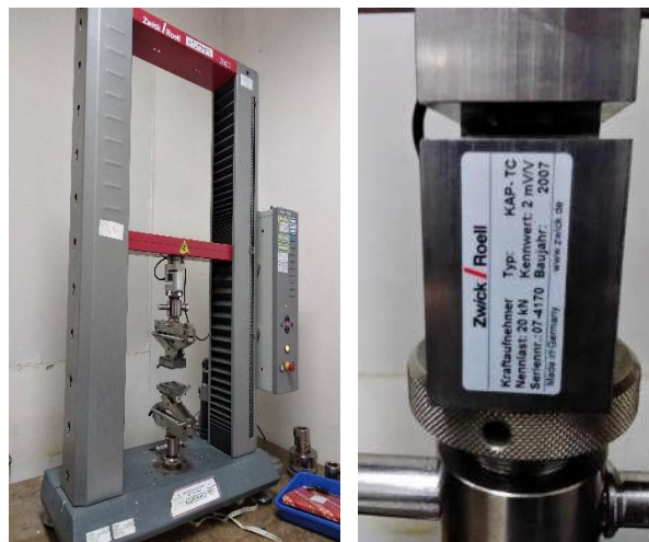
Gambar 3.15 Alat Uji Tarik Serat Tunggal
