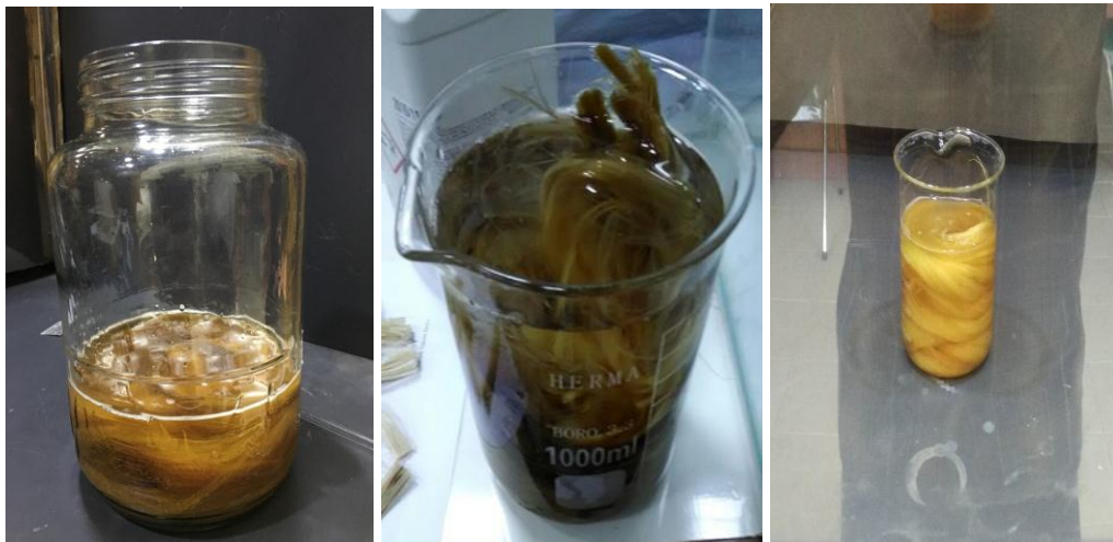
Gambar 3.33 Perendaman Serat Alam Dengan NaOH
