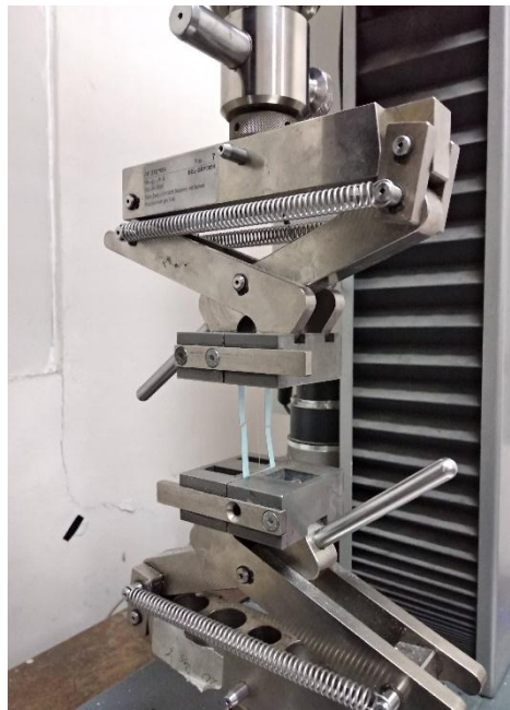
Gambar 3.42 Pemasangan spesimen uji tarik serat tunggal
