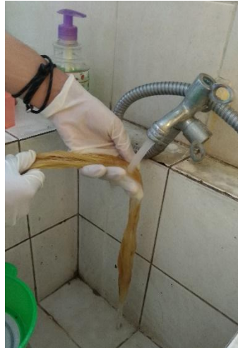
Gambar 3.36 Proses Pembilasan Serat Alam
