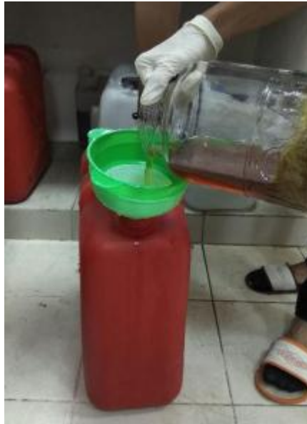
Gambar 3.34 Membuang air rendaman ke dalam jerigen penyimpanan limbah
