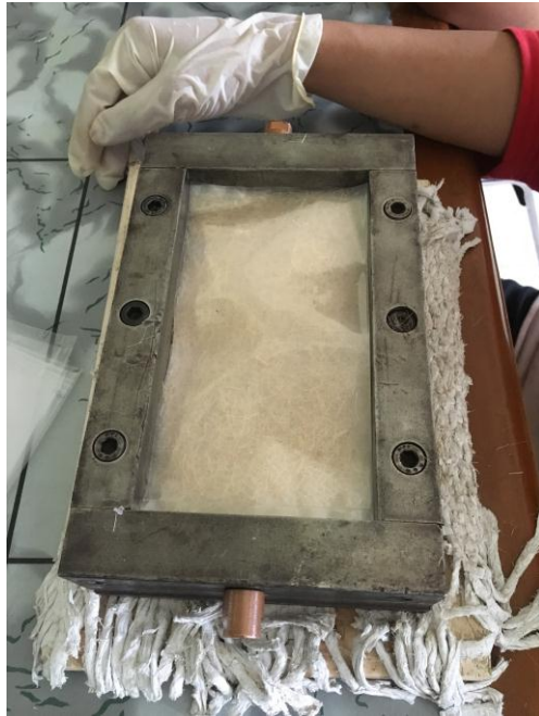
Gambar 3.45 Proses Penyusunan Polipropilen
