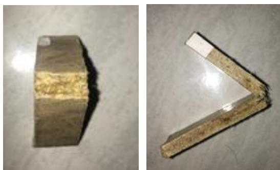
Gambar 3.52 Hasil Patahan Uji Impak
