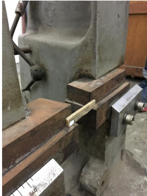
Gambar 3.51 Proses Peletakan Spesimen
