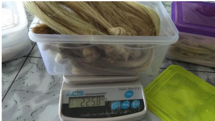
Gambar 3.30 Proses Menimbang Serat
