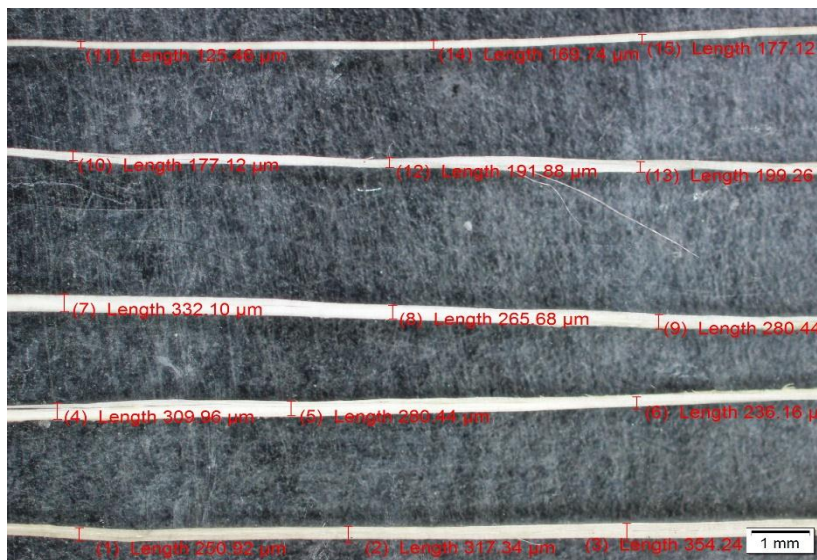
Gambar 3.40 Hasil pengukuran diameter serat menggunakan mikroskop
