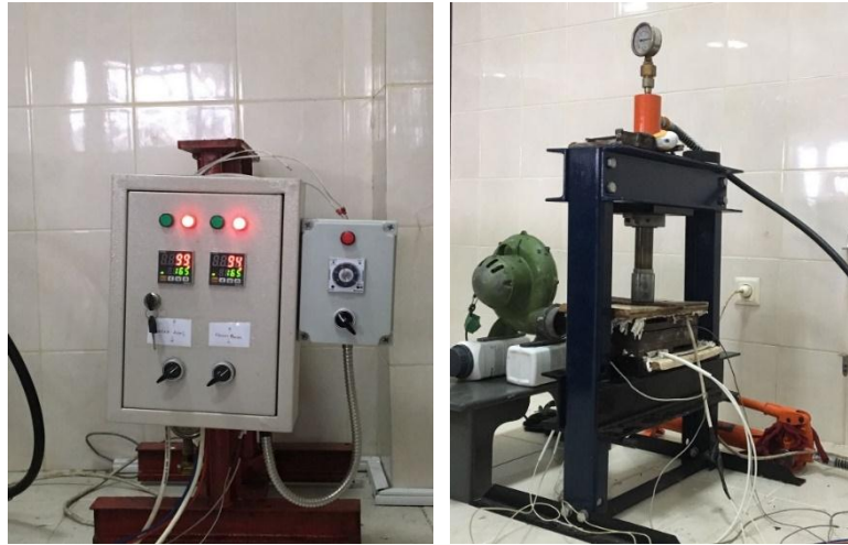
Gambar 3.10 Hot Press dan Control Box
