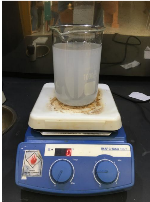
Gambar 3.32 Proses Pelarutan NaOH Dengan Aquades
