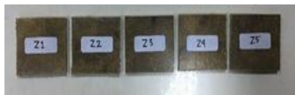
Gambar 4.6 Spesimen uji daya serap air
