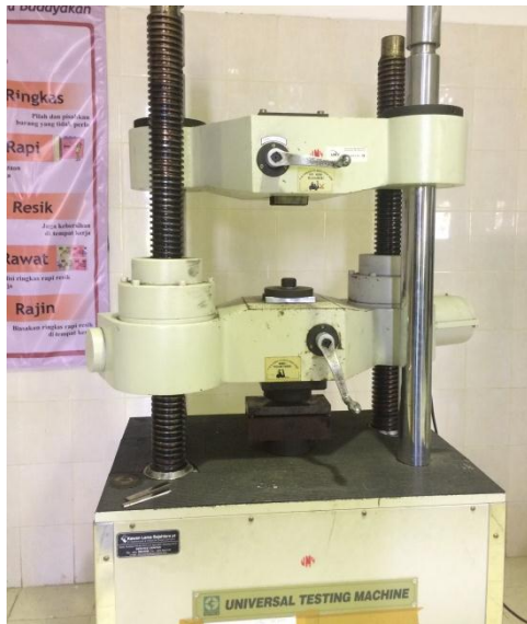
Gambar 4 Proses penekuk (pem-bending) plat
