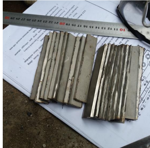
Gambar 1. Proses Pemotongan Plat SS-316L
