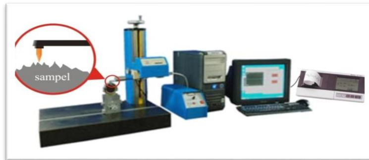
Gambar 2.12 alat uji kekasaran permukaan dan skema pembacaan *stylus* (Widi, 2016)
