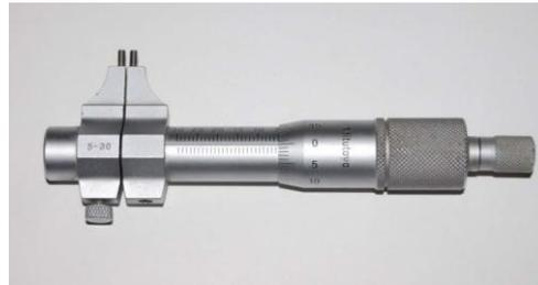
Gambar 2.18 Mikrometer dalam (*inside micrometer*)
