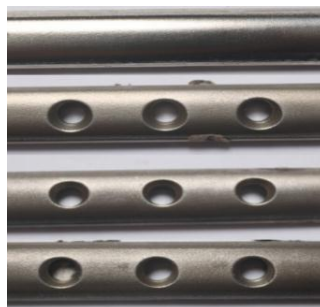
Gambar 3. Spesimen shot peening variasi waktu (a) spesimen raw material , (b) 8 menit, (c) 10 menit, (d) 12 menit.
