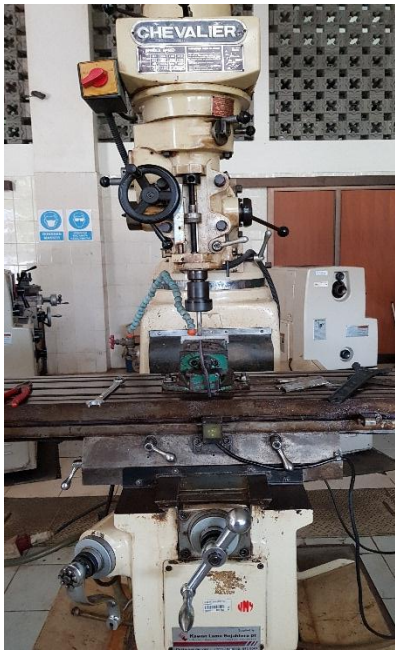
Gambar 2. Proses Pemesinan Menggunakan Mesin Frais dengan End Mill
