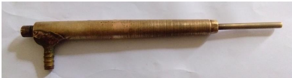
Gambar 2.12. Tool elektroda Kuningan.
