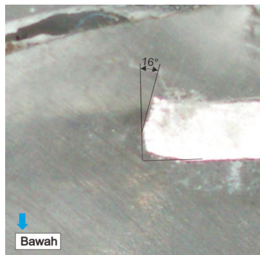
Gambar 4.17. Hasil ketirusan pada gap 0.5 mm di- masking .
