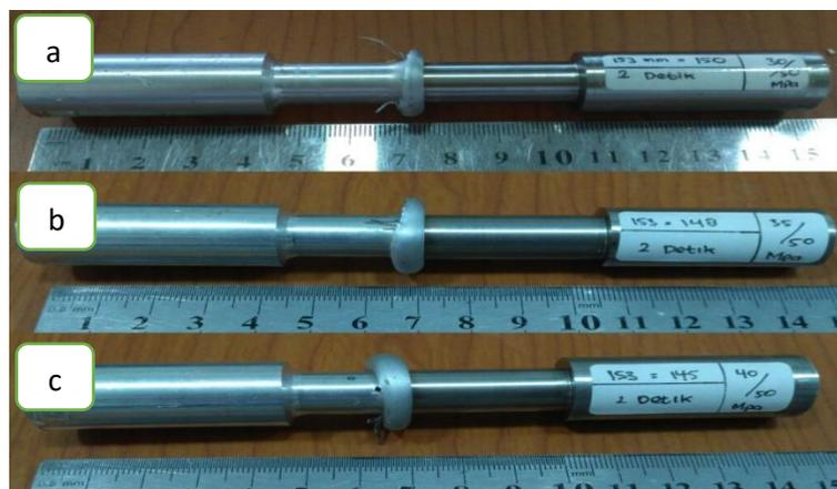
**Gambar 4.1** Hasil Pengelasan Gesek (a) 30 MPa, (b) 35 MPa, dan (c) 40 MPa.
