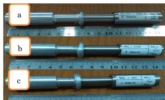
**Gambar 5.** Hasil Pengelasan Gesek (a) 30 MPa, (b) 35 MPa, dan (c) 40 MPa
