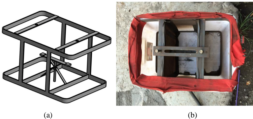
Gambar 3.16 Pembuatan mesin shot peening ; (a) kerangka mesin shot peening (b) mesin shot peening yang digunakan selama proses shot peening
