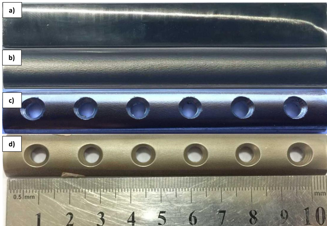
Gambar 3.15 Pembuatan Spesimen DCP. a) Plat SS-316L. b) spesimen raw material . c) Dynamic compression plate setelah proses drilling . d) Dynamic compression plate setelah shot peening .
