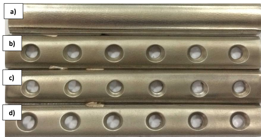
Gambar 4.1 Hasil foto visual permukaan dari spesimen DCP (a) spesimen raw material (b) spesimen shot peening variasi diameter 0,4 mm (c) spesimen shot peening variasi diameter 0,6 mm (d) spesimen shot peening variasi diameter 0,7 mm.
