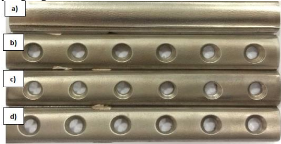
Gambar 1 (a) spesimen raw material , spesimen shot peening variasi diameter steel ball (b) 0,4 mm, (c) 0,6 mm, (d) 0,7 mm.
