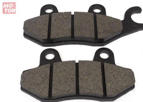
**Gambar 2.3** Kampas Rem Sepeda Motor
