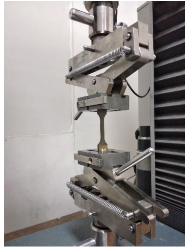
Gambar 3.52 Pemasangan spesimen uji tarik
