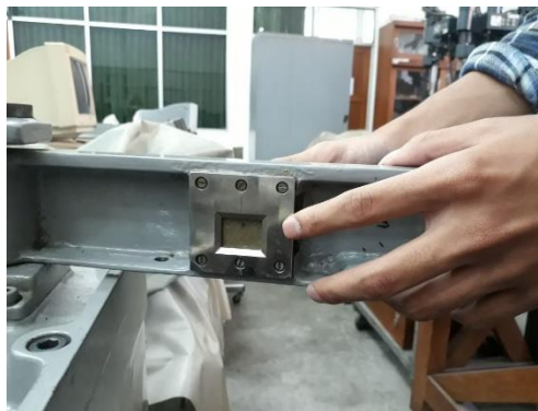
Gambar 3.45 pemasangan spesimen uji keausan
