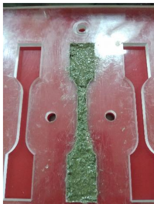
Gambar 3.42 Bahan komposit dituang kedalam cetakan
