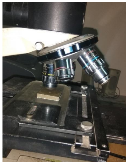
Gambar 3.47 Pengamatan hasil goresan menggunakan mikroskop
