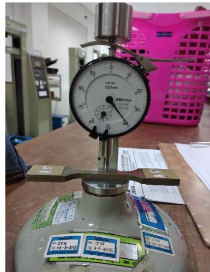
Gambar 3.50 mengukur tebal menggunakan dial indicator
