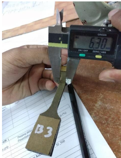
Gambar 3.49 mengukur lebar menggunakan jangka sorong
