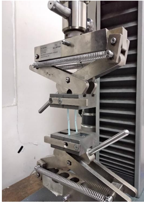
Gambar 3.34 Pemasangan spesimen uji tarik serat tunggal
