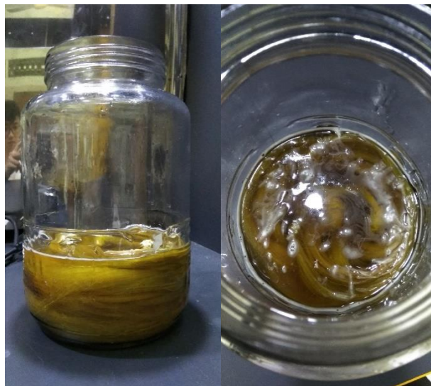
Gambar 3.25 Alkalisasi serat nanas
