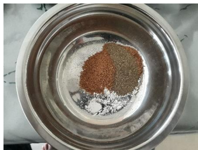
Gambar 3.19 Pencampuran serbuk kayu, kuningan, & MgO
