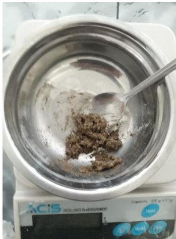
Gambar 3.21 Pencampuran epoxyresin dengan filler
