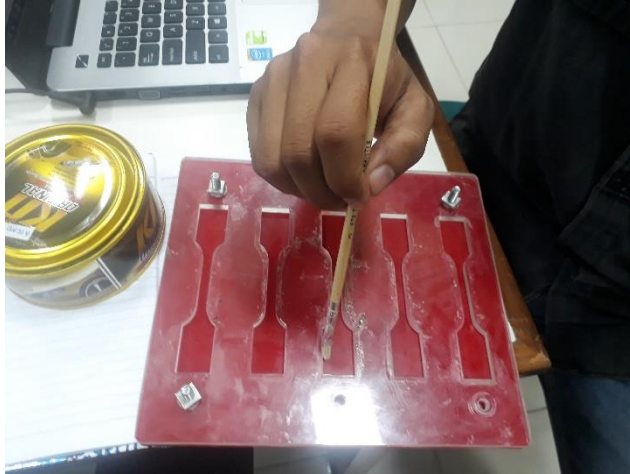
Gambar 3.15 Pelapisan cetakan dengan kit
