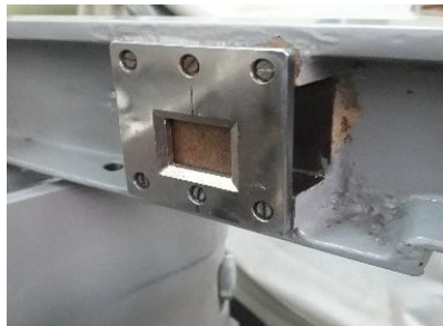
Gambar 3.28 Pemasangan spesimen uji
