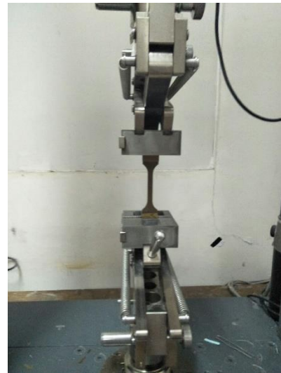
Gambar 3.27 Pemasangan spesimen uji tarik
