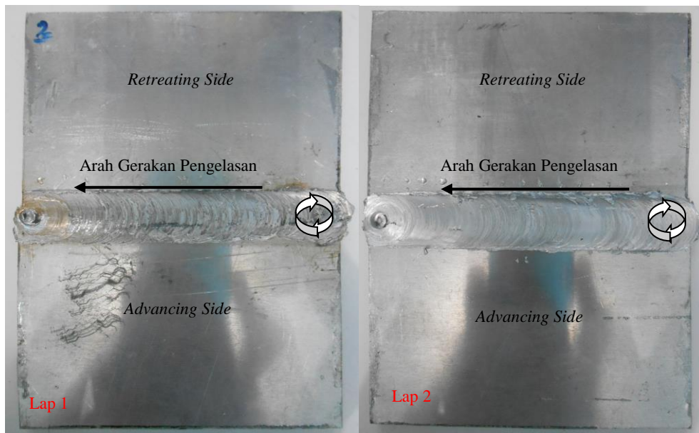
Gambar 4.3 Hasil pengelasan FSW dua sisi variasi putaran tool 2300 rpm
