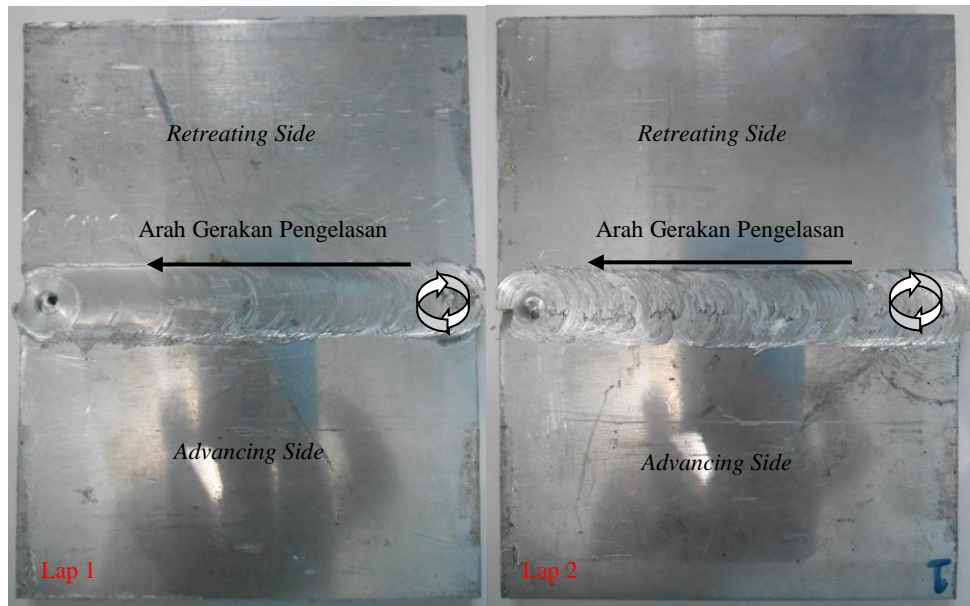
Gambar 4.2 Hasil pengelasan FSW dua sisi variasi putaran tool 1500 rpm
