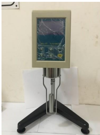
Gambar 3.21 Rangkaian Penyangga Beserta Viskometer NDJ 8S
