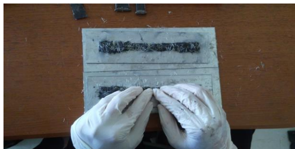
Gambar 3. 27 Menata serat pada cetakan
