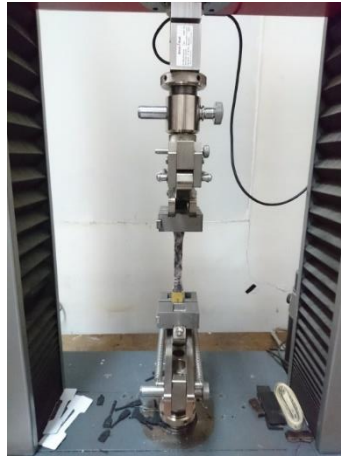
Gambar 3. 30 Memasang spesimen pada alauji tarik
