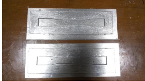
Gambar 3. 25 Molding atau cetakan ASTM D638-01
