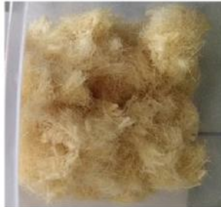
Gambar 3. 23 serat sisal alkali yang sudah dipotong
