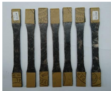
Gambar 3. 29 Spesimen yang dipasang amplas dibagian ujungnya
