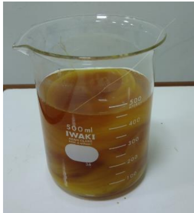
Gambar 3. 22 Proses alkalisasi serat sisal
