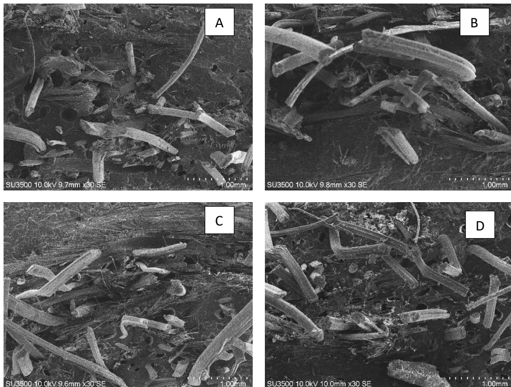
Gambar 4. 6 Struktur patahan hasil uji sem (A) Perendaman asam nitrat 24 jam, (B) Perendaman asam nitrat 48 jam, (C) Perendaman asam nitrat 72 jam, (D) Perendaman asam nitrat 96 jam
